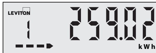
Figure 7 – Exemple d'écran en mode de fonctionnement normal
