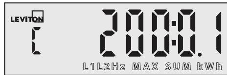
Pantalla de inicio de Amperaje del TC, sin condiciones de error
