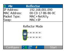
Figure 26. Reflector Mode Screen
