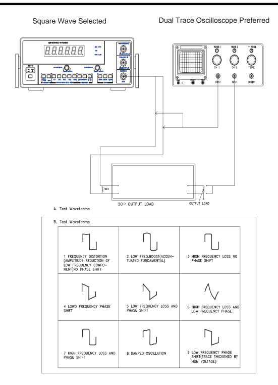
FIG 7. AMPLIFIER PERFORMANCE EVALUATION USING SQUARE WAVES.
