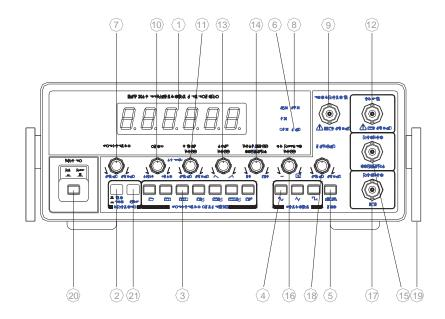
FIG 1-1. FRONT PANEL OPERATOR'S CONTROLS(FG-7002C)
