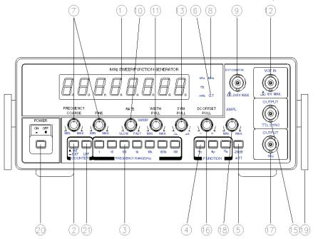
FIG 1-2. FRONT PANEL OPERATOR'S CONTROLS(FG-7005C,)
