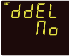
Fig 3-10 DI Counter Reset
